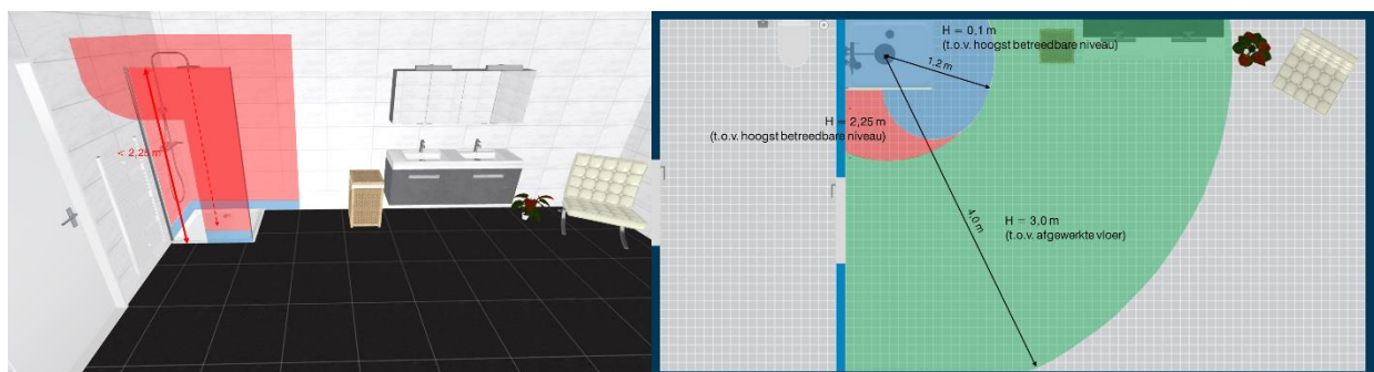
Figure 5 – Douche avec profondeur receveur de douche < 0,10 m – hauteur paroi de douche inférieure à 2,25m
